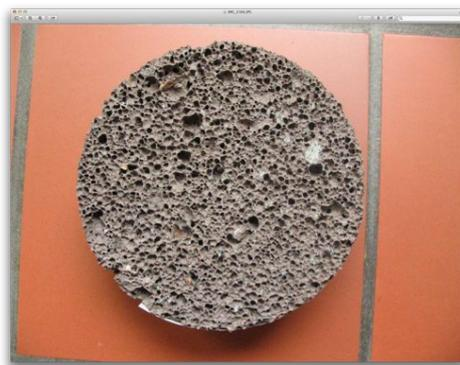
Schnitt durch einen Bohrkern: porige Basaltlava
